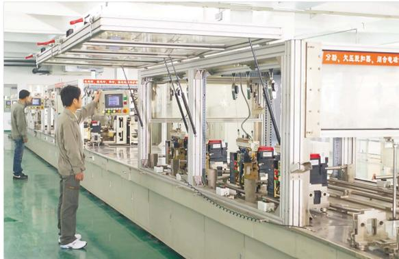
智能型万能式断路器自动检测线：主要由机械特性检测单元；保护特性测单元；耐压测试单元；终端测试单元及辅助吊升工作站等组成，同时配有随行夹具和随行托盘。
