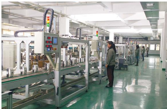
塑料外壳式断路器自动检测线：由具有触头开距、超程测试单元；回路电阻、终压力、脱口力及行程测试单元、瞬时、延时特性测试单元；耐压测试单元及三检串联延时检验单元构成。
